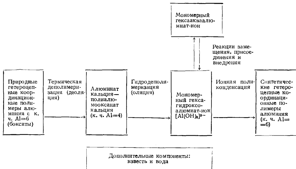
Рис. 2. Схема полимерных превращений алюминатной составляющей глиноземистого цемента
